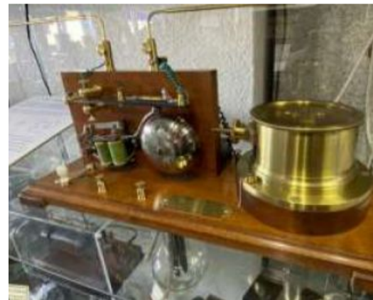
Der Morse-Empfänger - mit Metallspahn-Glasröhrchen, um elektrischen Widerstand zu wandeln.
