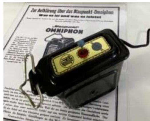
„Der blaue Punkt“: Die kleine blaue Kugel allein (Körperschalllautsprecher) verteilt Ton über die Luft.
