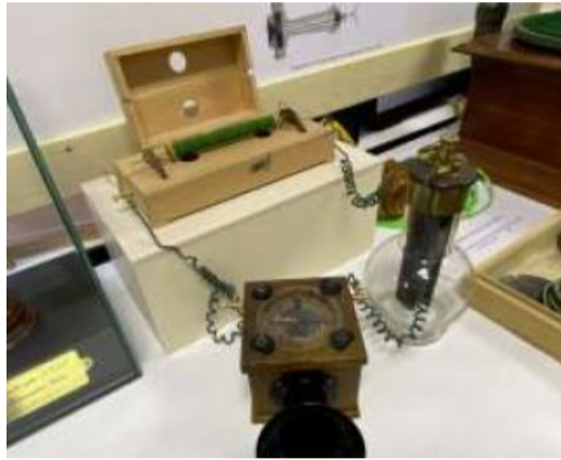
„Die sprechende Stricknadel“ (ein Nachbau) gilt als erster Lautsprecher der Welt - 1861, Philipp Reis.
