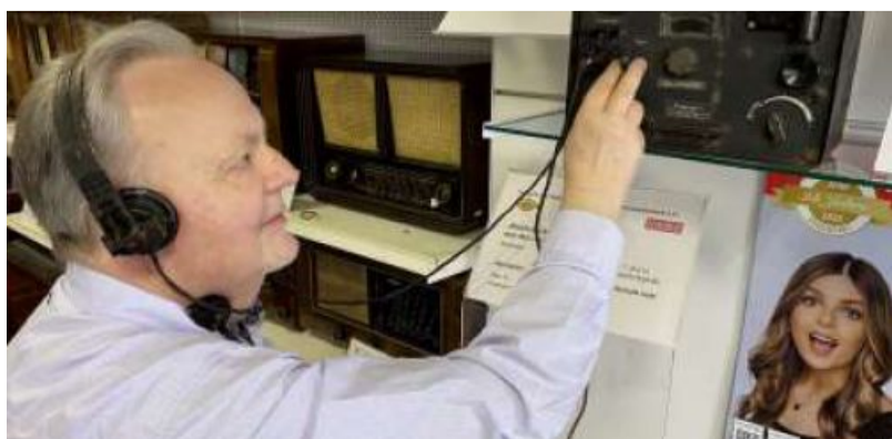
Funkgerät Staßfurter Bauart, wie es etwa die Rote Armee der Sowjets in die Hauben einbaute. Ab Mitte der 1930er, mit Kehlkopfmikrofon und Kopfhörer.
