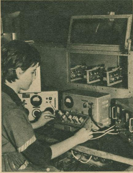
Nach Vorheizung und Alterung erfolgt der Abgleich und die Prüfung der Bild-ZF-Verstärkerstufe.
